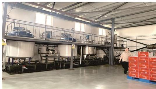
图 7 北方稀土冶炼废水制备农肥和土壤改良剂生产线
