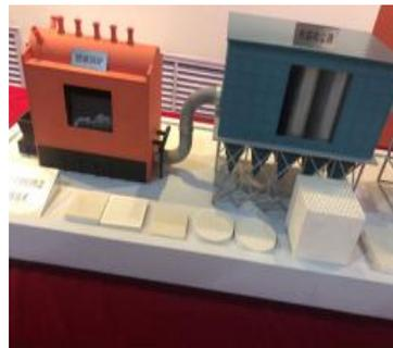
图 39 利用粉煤灰炉渣制备的烟气脱硫催化剂
